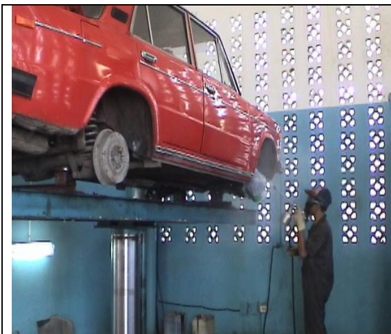
Fig. 9. Observe la aplicación por proyección de la grasa líquida a un área inaccesible que puede ser convertida en área cerrada.
