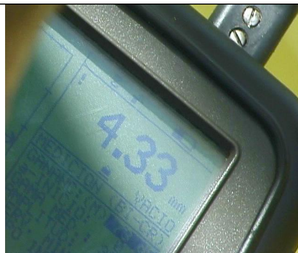
Fig. 8. Observe la medición para un espesor nominal de pared de 6 mm.
