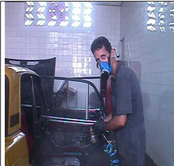
Fig. 11. Observe la aplicación de la grasa líquida en el interior de una puerta.
