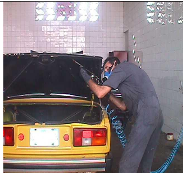
Fig. 12. Observe la aplicación de la grasa líquida en el interior del maletero..
