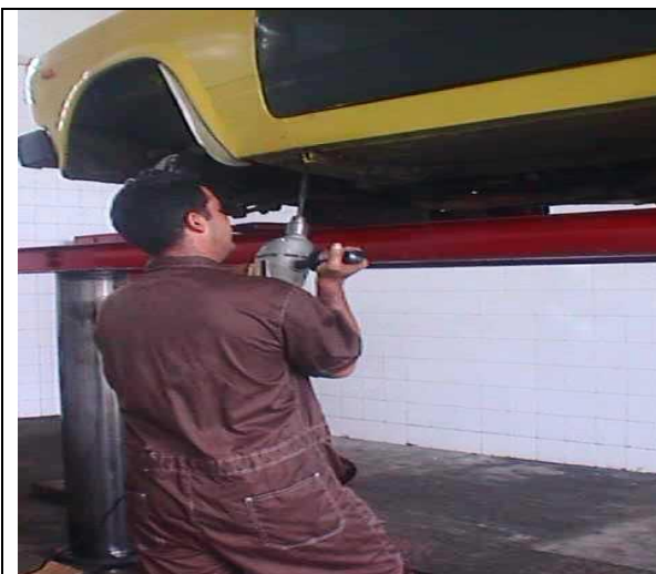
Fig. 13. Observe como se le realiza una abertura con el taladro para introducir la grasa líquida en el componente hueco.
