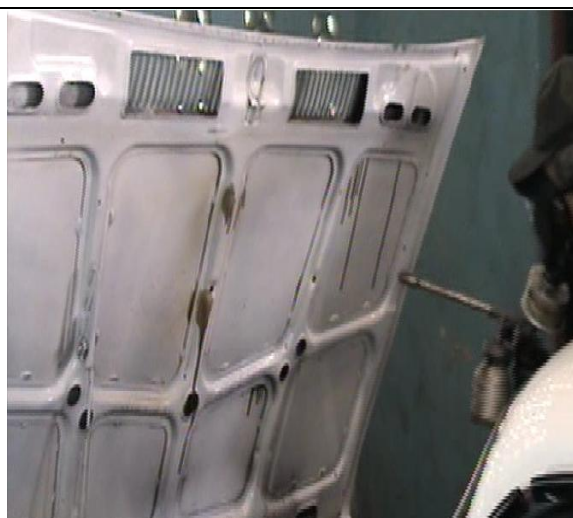
Fig. 14. Observe la protección interior que se realiza a los componentes huecos con grasa líquida DISTIN 314 L.
